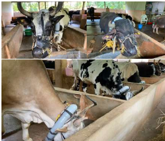
चित्र 30: सल्फर हेक्साफ्लोराइड (SF6) ट्रेसर तकनीक उपयोग करके मवेशियों और भैंसों में आंत्रिक मीथेन उत्सर्जन का अनुमान
